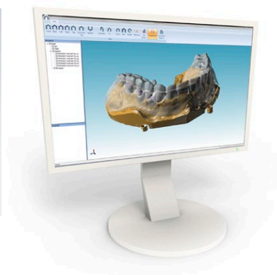
Фрезерование супраструктур имплантата Atlantis выполняется только после проверки и окончательного утверждения CAD-дизайна в приложении Atlantis Viewer.
