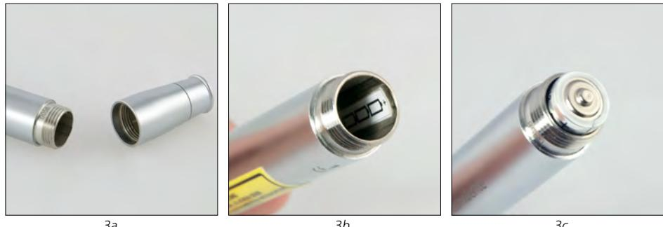
РИС 3 – **a.** Открытая крышка батареи, **b.** Вид на ячейку для батарей с иллюстрацией их правильного положения, **c.** Установленные батареи.
